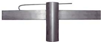
рис. 5. Распределитель воздуха для угля
